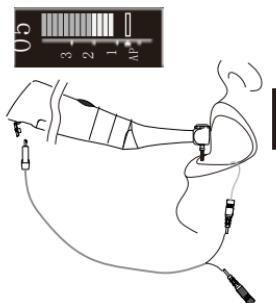
При использовании устройства в качестве мотора в сочетании с апеклокатором к мотору необходимо подсоединить измерительный кабель через USB-гнездо . Белое гнездо предназначено для загубника (контакт с губой). Черное гнездо в данном случае не используется . На экране появляется шкала точек отсчета (подробную информацию о шкале точек отсчета см . в разделе «Экран дисплея»).
